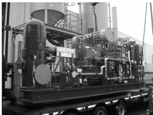
شکل ۴: دیزل پمپ آتشنشانی با پمپ عمودی توربینی. محور و قطعات هیدرولیکی پمپ جداگانه حمل می شود.
